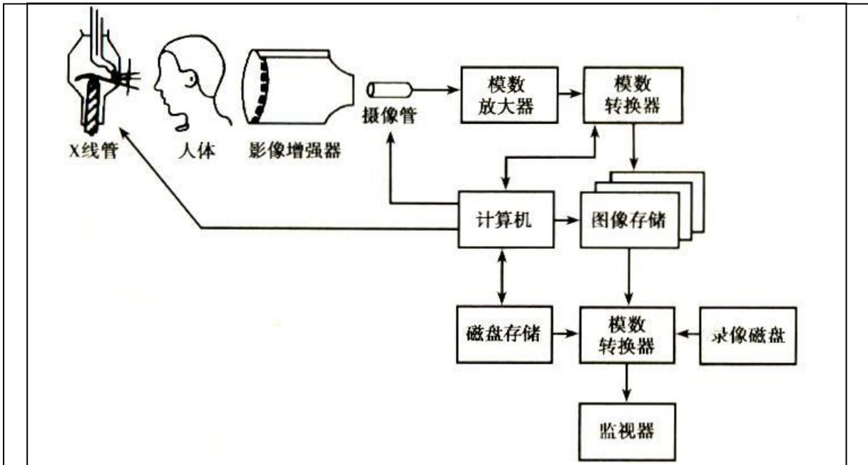
图 9-2 DSA 系统结构图
