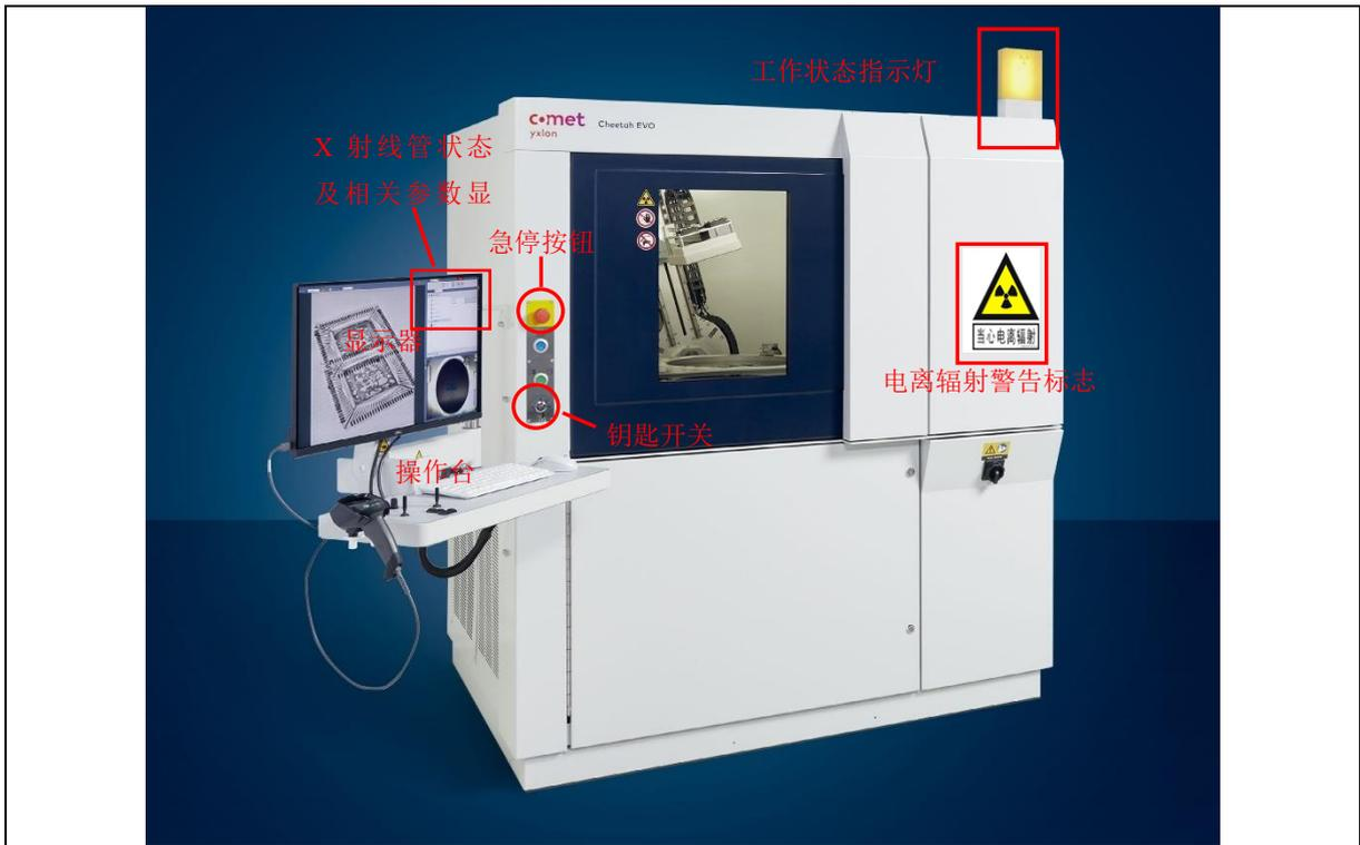
图 10-3 本项目辐射安全设施布设示意图
