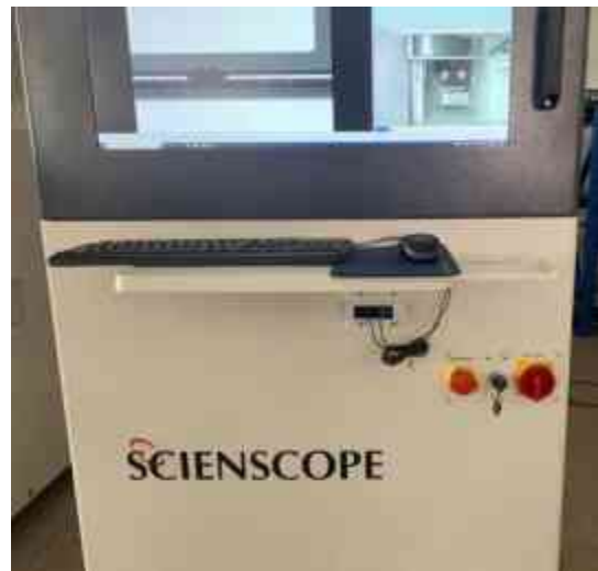
(d) Xspection 1860型和View X1820型自屏蔽式X射线探伤装置
