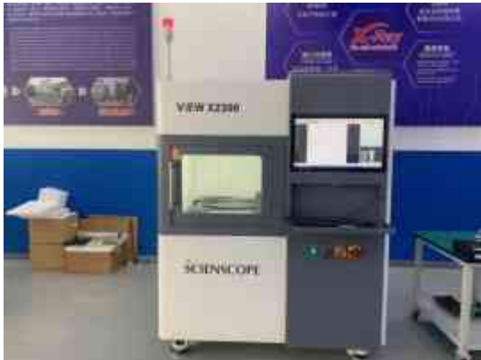
(b) Xspection 3000型和View X2300型自屏蔽式X射线探伤装置
