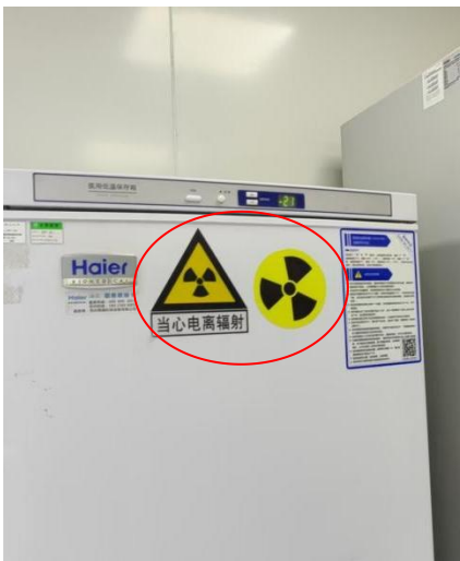
核素储存柜上电离辐射警告标志及 电离辐射标志
