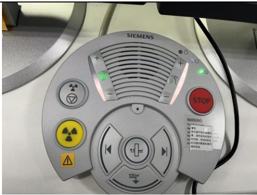
PET/CT控制室急停开关和对讲装置
