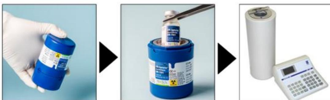
图 9-1  $^{90}\text{Y}$  树脂微球总活度测量步骤示意图
