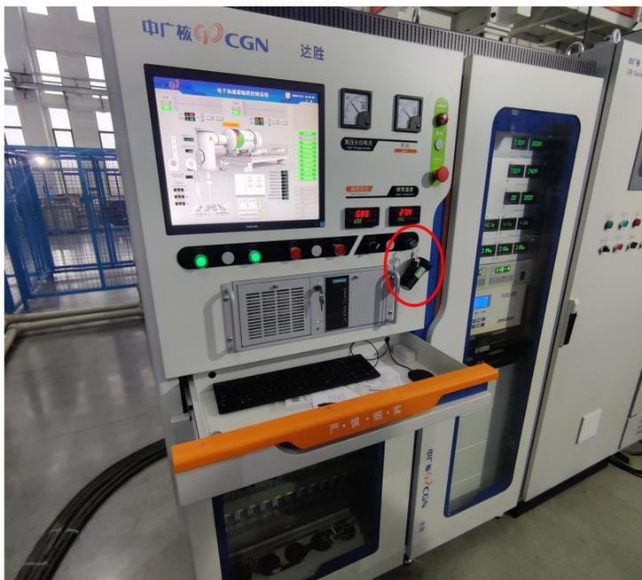
图3-3 加速器钥匙开关
