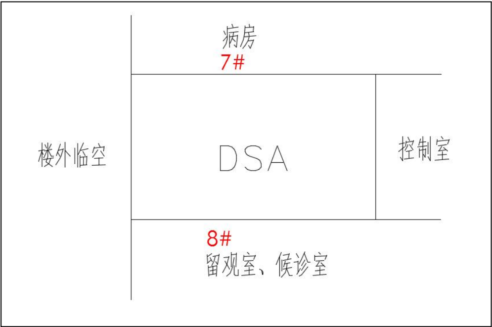
图 11-2 DSA 室预测计算参考点位布设示意图
