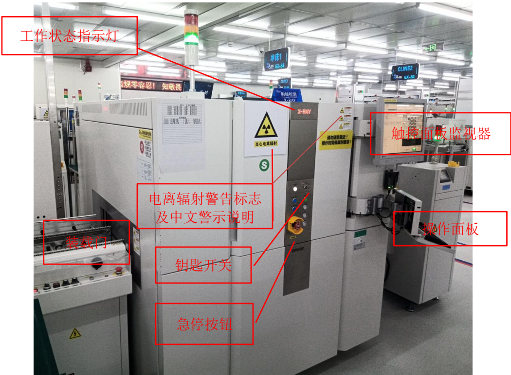
图3-2 本项目工业CT现场照片
